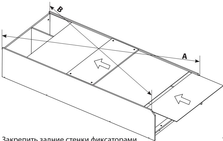
Закрепить задние стенки фиксаторами
