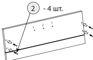
Ручка скоба: досверлить отв. 1 сверлом d=5 мм,
