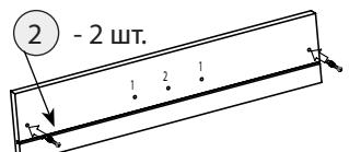
Ручка скоба: досверлить отв. 1 сверлом d=5 мм,
