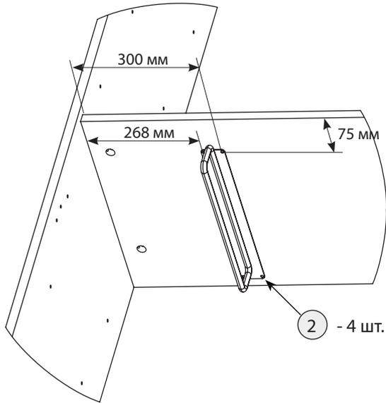
Схема установки ответных планок (см. шаг 11)
