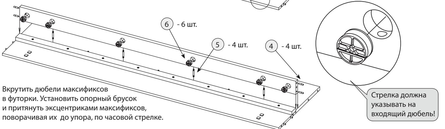
Вкрутить дюбели максификсов в футорки. Установить опорный брусок и притянуть эксцентриками максификсов, поворачивая их до упора, по часовой стрелке.
