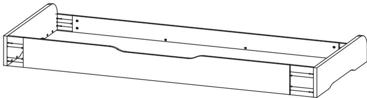
Притянуть боковые стенки, поворачивая эксцентрики минификсов до упора, по часовой стрелке.
