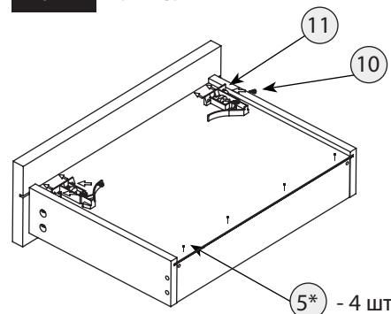
\*Необходимо предварительно просверлить отверстия строго по центру торца задней стенки сверлом d=3мм, глубиной 25мм. Количество отверстий = количеству шурупов.
