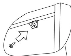
Закрепить задние стенки фиксаторами, как показано на рисунке.
