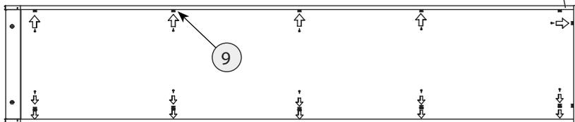
Прибить гвоздями стенку заднюю к стенке нижней и полкам, согласно схеме.
