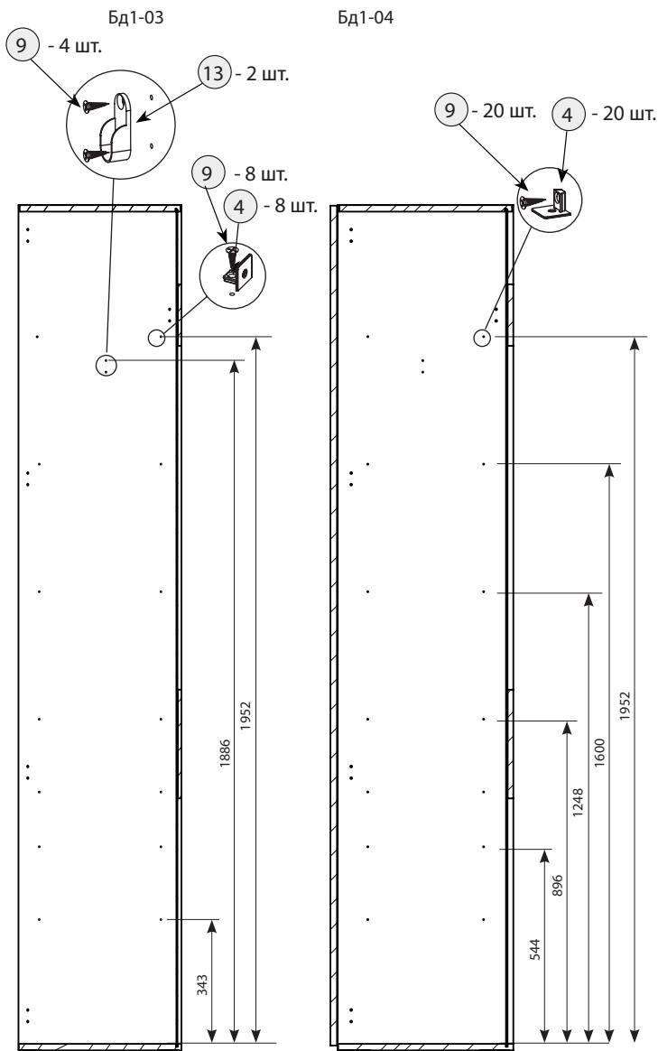
**Шаг 13** Разметить положение полок карандашом, как показано на рисунке, слева и справа. Задвинуть заднюю стенку в пазы до упора.
