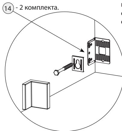
Изделие должно быть прикреплено к стене с помощью прилагаемого крепежа который подходит для крепления шкафа к стене из бетона или кирпича без пустот. Всегда выбирайте крепеж который подходит к материалу Ваших стен. Если прилагаемый крепеж не подходит к вашим стенам обратитесь в специализированный магазин.
