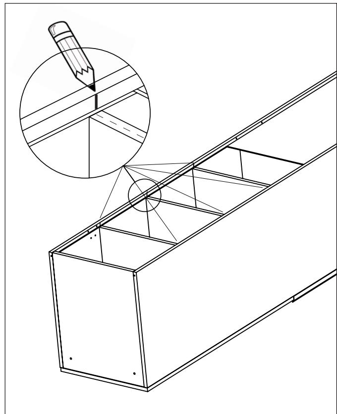
Разметить места крепления задней стенки на гвозди по сделанным меткам. Заднюю стенку, прибить гвозди согласно разметке.
