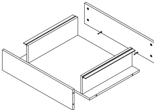
После соединения эксцентрики закрутить по часовой стрелке до упора.
