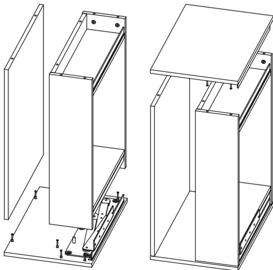
После соединения эксцентрики закрутить по часовой стрелке до упора.
