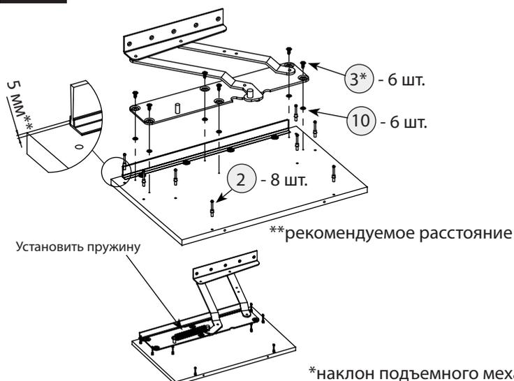
\*наклон подъемного механизма можно скорректировать с помощью шурупов в пределах +/- 2 мм
