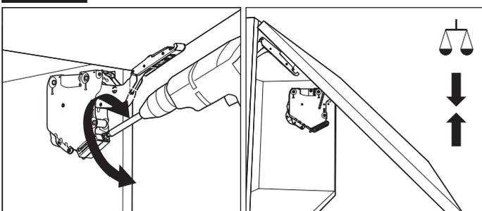
Отрегулируйте усилие откидывания двери на подъемнике с литерой Е. Дверь должна останавливаться в любом положении при открытии на угол больше 45°. Подъемник с литерой А не регулируется.
