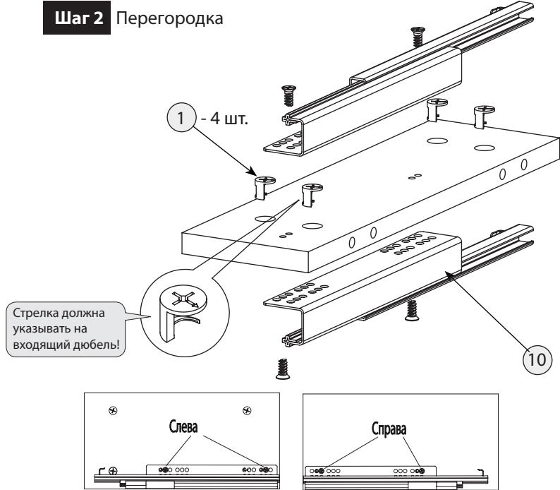
Схема крепления направляющих на перегородке
