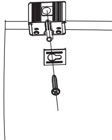
**ВНИМАНИЕ!** Изделие должно быть прикреплено к стене с помощью прилагаемого крепежа который подходит для крепления шкафа к стене из бетона или кирпича без пустот. Всегда выбирайте крепеж который подходит к материалу Ваших стен. Если прилагаемый крепеж не подходит к Вашим стенам обратитесь в специализированный магазин
