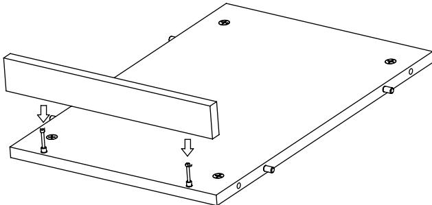
После соединения эксцентрики закрутить по часовой стрелке до упора.
