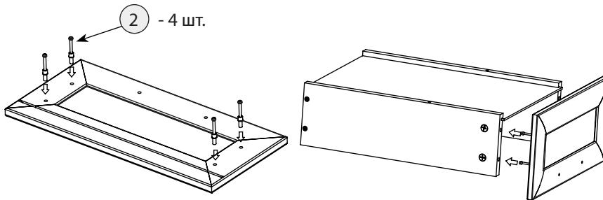
После соединения эксцентрики закрутить по часовой стрелке до упора.
