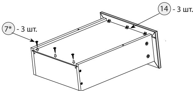
\*Необходимо предварительно просверлить отверстия строго по центру торца задней стенки сверлом d=3мм, глубиной 25мм. Количество отверстий = количеству шурупов.
