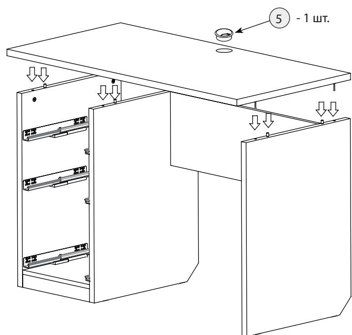
После соединения эксцентрики закрутить по часовой стрелке до упора.
