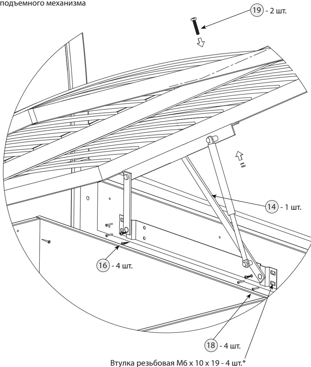
1. Закрутить болты (18) М6 х 20 и шурупы (16) 4,2 - 4,8 х 25.
