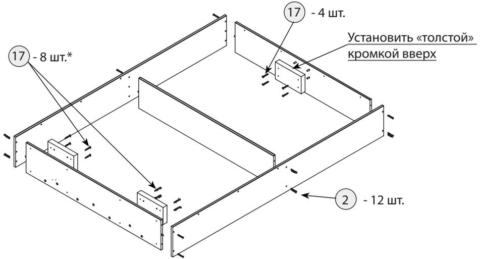
**Шаг 5** Крепление дна к каркасу ящика
