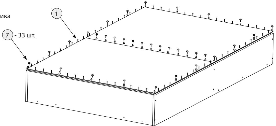
**Шаг 6** Аналогично наклеить войлочные подпятники на ортопедическое основание (отсчет со стороны отверстий под подъемный механизм)
