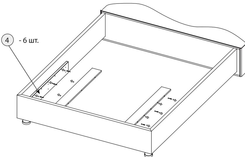
После соединения эксцентрики закрутить по часовой стрелке до упора.
