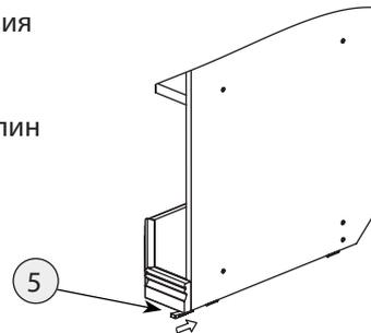
**Шаг 24** После установки изделия и регулировки всех механизмов необходимо все отверстия и видимые эксцентрики минификсов закрыть заглушками.
