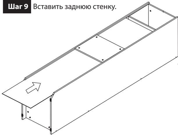
Закрепить задние стенки фиксаторами, как показано на рисунке. Прибить гвоздями стенку заднюю к стенке нижней и полкам, согласно схеме.
