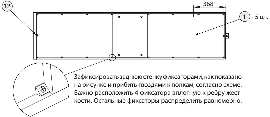
Зафиксировать заднюю стенку фиксаторами, как показано на рисунке и прибить гвоздями к полкам, согласно схеме. Важно расположить 4 фиксатора вплотную к ребру жесткости. Остальные фиксаторы распределить равномерно.
