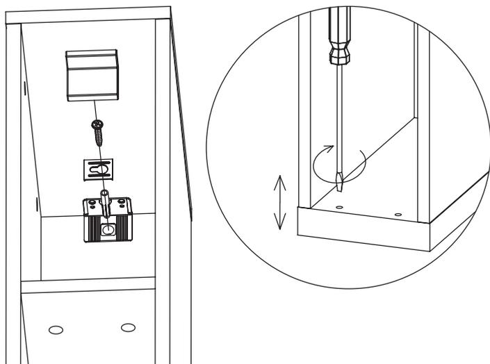
Изделие должно быть прикреплено к стене с помощью прилагаемого крепежа который подходит для крепления шкафа к стене из бетона или кирпича без пустот.
