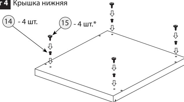
\* - подпятник войлочный (17) использовать в зависимости от типа напольного покрытия (по необходимости), чтобы избежать его повреждение
