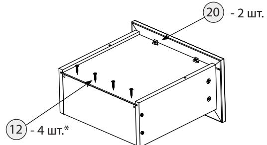
\*Необходимо предварительно просверлить отверстия строго по центру торца задней стенки сверлом d=3мм, глубиной 25мм. Количество отверстий = количеству шурупов.
