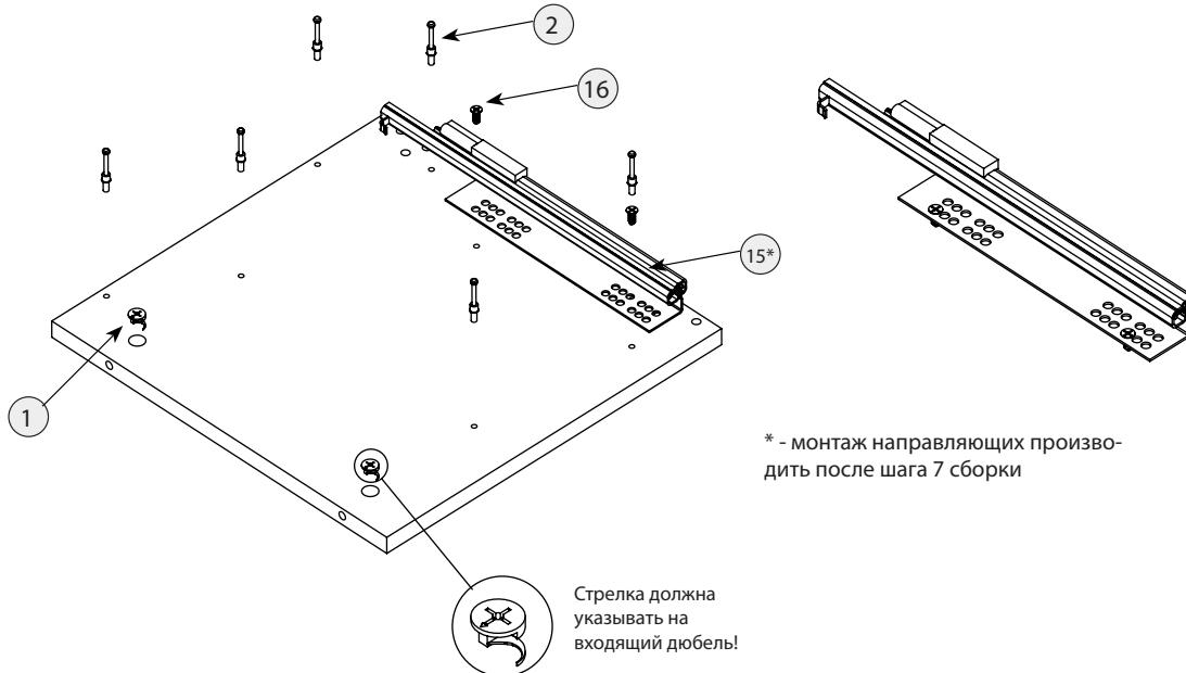
\* - монтаж направляющих производится после шага 7 сборки
