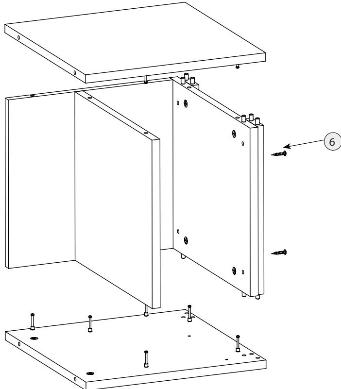
После соединения эксцентрики закрутить по часовой стрелке до упора.
