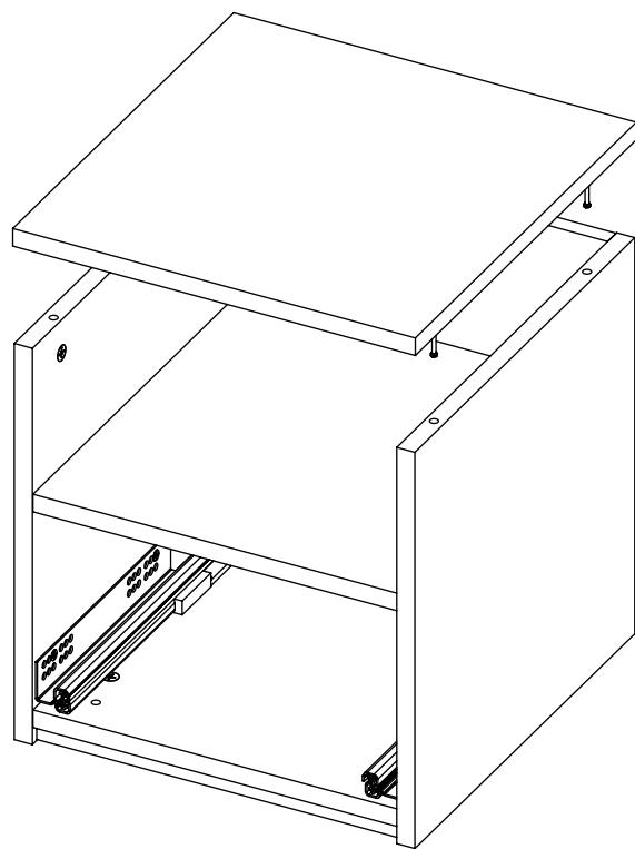
После соединения эксцентрики закрутить по часовой стрелке до упора.
