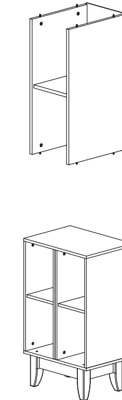
Пример установки двух модулей Бг1-43 на основание Бг1-80.
