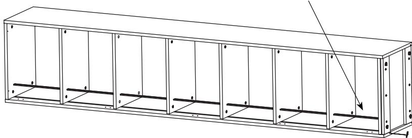
**Шаг 11** Установите фиксаторы задней стенки и прибейте заднюю стенку к полке гвоздями
