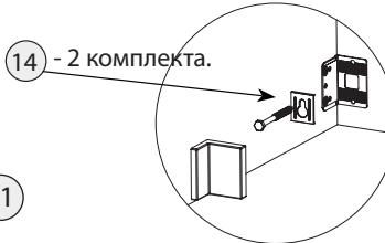
Изделие должно быть прикреплено к стене с помощью прилагаемого крепежа который подходит для крепления шкафа к стене из бетона или кирпича без пустот. Всегда выбирайте крепеж который подходит к материалу Ваших стен. Если прилагаемый крепеж не подходит к вашим стенам обратитесь в специализированный магазин.
