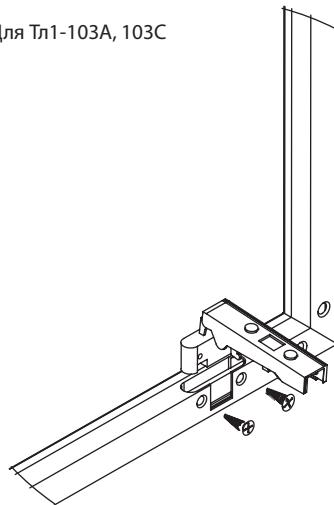
Наложить на монтажную планку, заведя в пазы. Защелкнуть на монтажной планке нажатием
