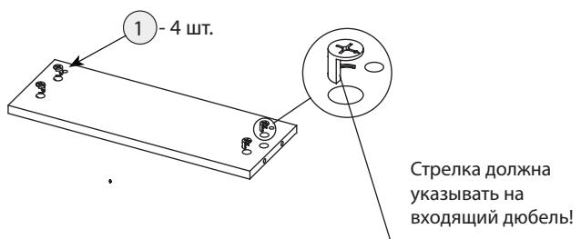
**Шаг 8** Установка планок монтажных
