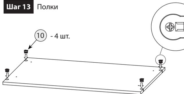
При затягивании стяжки RAFIX изнутри шкафа через отверстие  $d=8$ , затяжку производить против часовой стрелки
