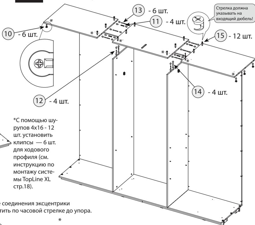
\*С помощью шурупов 4x16 - 12 шт. установить клипсы — 6 шт. для ходового профиля (см. инструкцию по монтажу системы TopLine XL стр.18).
