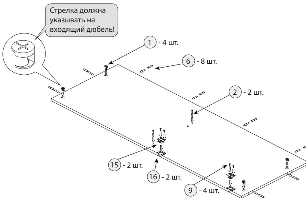
**Шаг 4** Установка стенок боковых и перегородки на стенку нижнюю, для Лз1-23. Для Лз1-32 собирать симметрично
