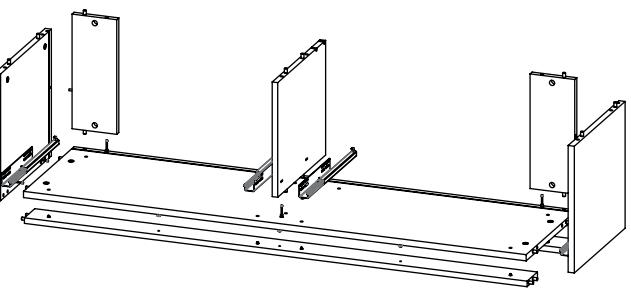
Схема крепления направляющих на перегородке
