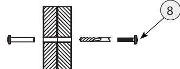
Изделие должно быть прикреплено к стене с помощью прилагаемого крепежа который подходит для крепления шкафа к стене из бетона или кирпича без пустот. Всегда выбирайте крепеж который подходит к материалу Ваших стен. Если прилагаемый крепеж не подходит к Вашим стенам обратитесь в специализированный магазин!
