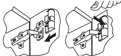
После установки зафиксировать при помощи винта.
