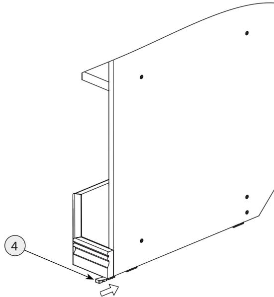
**Шаг 11** После установки изделия и регулировки всех механизмов необходимо все отверстия и видимые эксцентрики минификсов закрыть заглушками.
