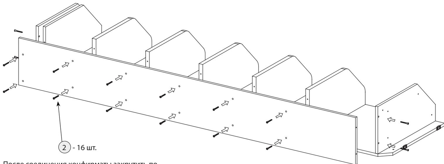
После соединения конфирматы закрутить по часовой стрелке с помощью ключа б.
