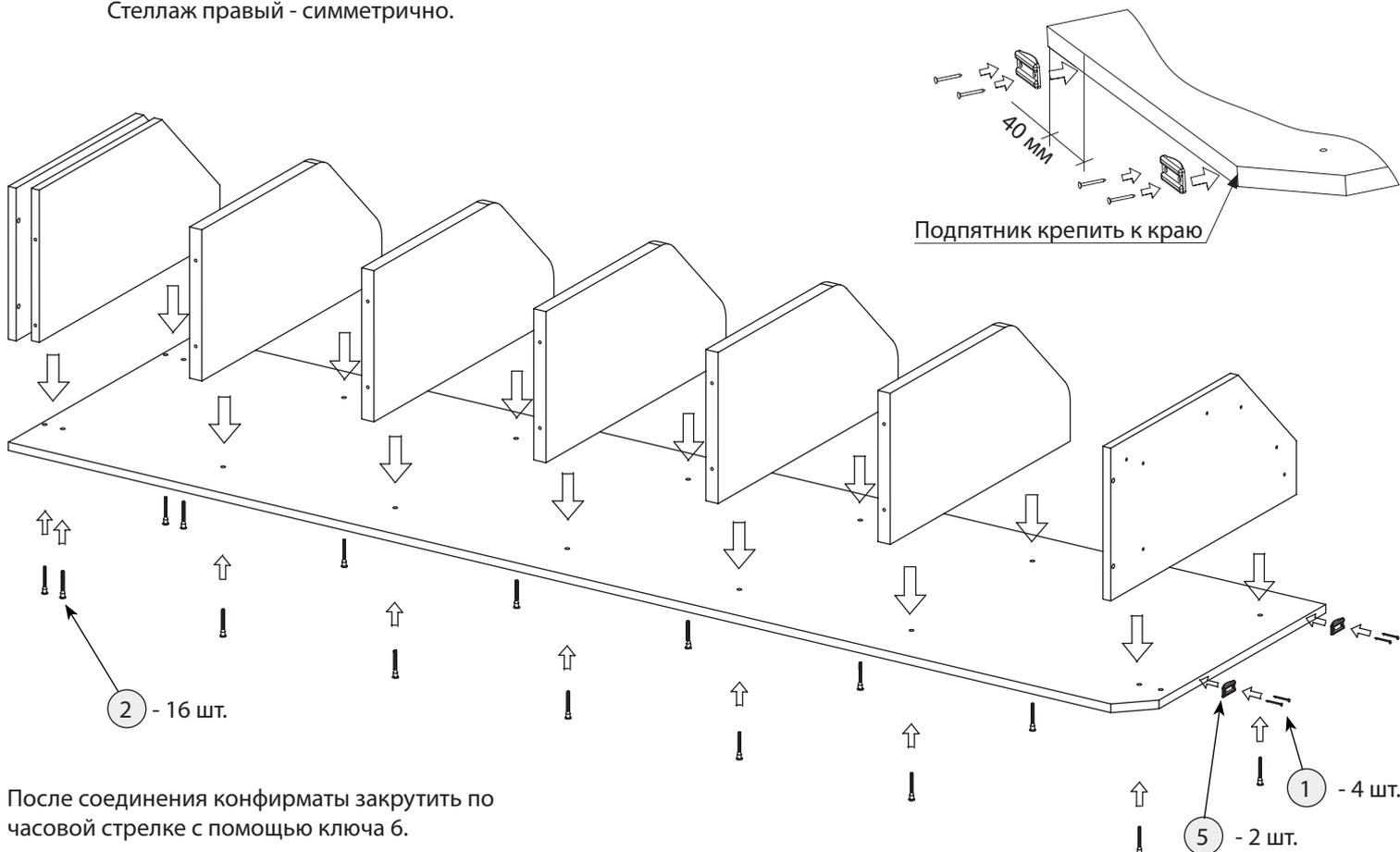
После соединения конфирматы закрутить по часовой стрелке с помощью ключа 6.
