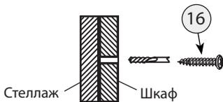
**ВНИМАНИЕ!** Если стеллаж используется как отдельное изделие, то он должен быть прикреплен к стене с помощью прилагаемого крепежа, который подходит для крепления к стене из бетона или кирпича без пустот. Всегда выбирайте крепеж который подходит к материалу Ваших стен. Если прилагаемый крепеж не подходит к Вашим стенам обратитесь в специализированный магазин.
