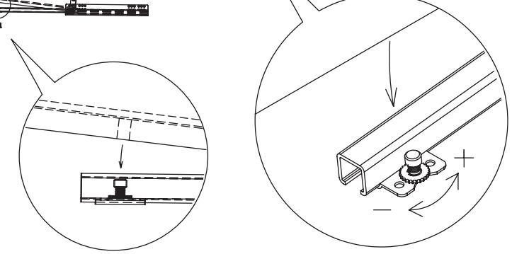
Регулировка ящика по высоте производится с помощью поворота регулировочного колесика (+3 мм)
