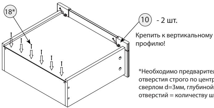
\*Необходимо предварительно просверлить отверстия строго по центру торца задней стенки сверлом d=3мм, глубиной 25мм. Количество отверстий = количеству шурупов.
