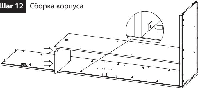
Установите полку и затяните полочные стяжки, поворачивая по часовой стрелке эксцентрик
