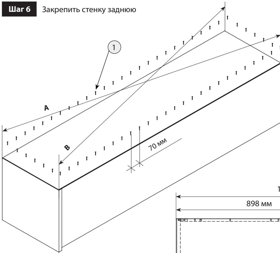
Прибить гвоздями одну длинную сторону задней стенки.
