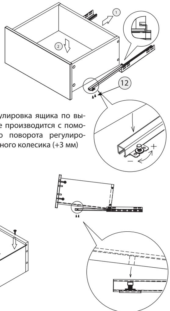
Регулировка ящика по высоте производится с помощью поворота регулировочного колесика (+3 мм)
