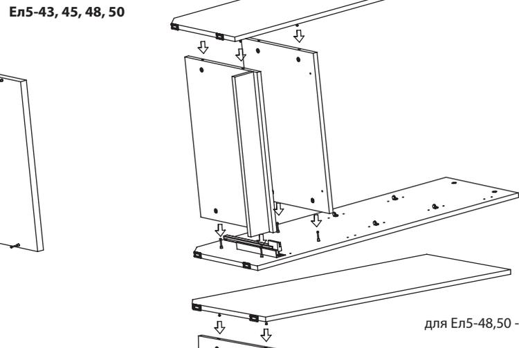
После соединения эксцентрики закрутить по часовой стрелке до упора.
