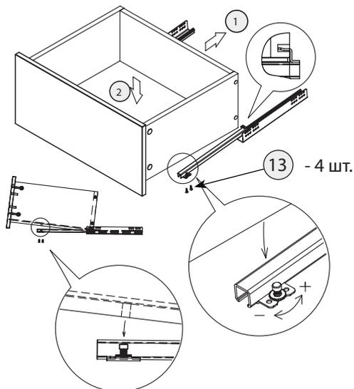
Регулировка ящика по высоте производится с помощью поворота регулировочного колесика (+3 мм)
