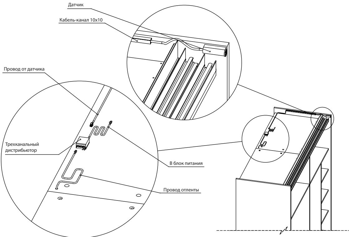
Для Нр1-03, Нр1-04 датчик открывания средней двери устанавливается в верхний горизонт. Датчики движения удобнее устанавливать до монтажа верхнего ходового профиля.
