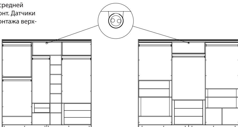
Досверлить ЛДСтП насеквосьм сверлом D=10 мм
