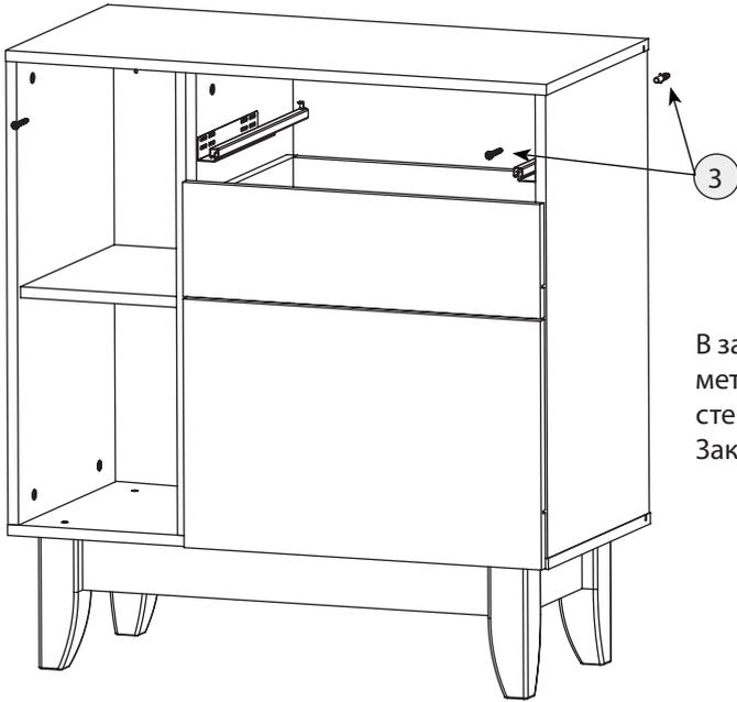
В задней стенке через ребро жесткости просверлить отверстие диаметром 5 мм и через него разметить место для установке дюбеля в стене.
