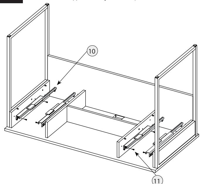
**Шаг 17** Установка монтажных планок
