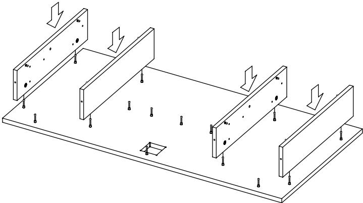
После соединения эксцентрики закрутить по часовой стрелке до упора.
