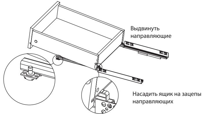
Регулировку фасада ящика по высоте можно осуществлять при помощи вращения регулировочного колесика до +2 мм.
