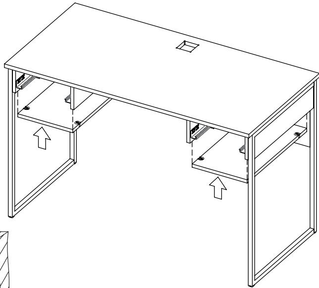
**Шаг 19** Установка ящиков и металлического пропускника
