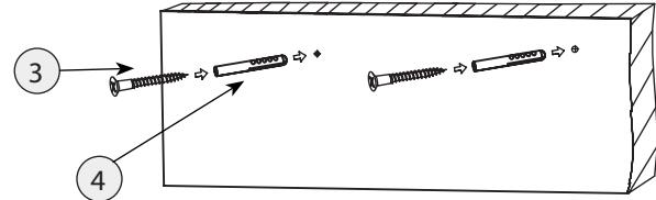
**Внимание!** Изделие должно быть закреплено на стене с помощью прилагаемого крепежа, который подходит для крепления шкафа к стене из бетона или кирпича без пустот. Всегда выбирайте крепеж, который подходит к материалу Ваших стен. Если прилагаемый крепеж не подходит к Вашим стенам, обратитесь в специализированный магазин.
