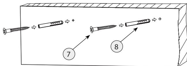
Предварительно просверлить отверстия диаметром 5 мм в задней стенке комода.
