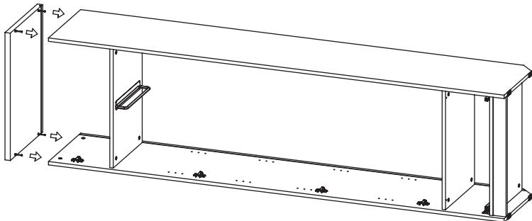
После соединения эксцентрики закрутить по часовой стрелке до упора.
