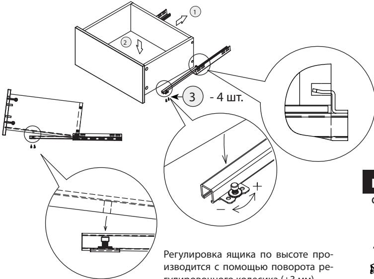
Регулировка ящика по высоте производится с помощью поворота регулировочного колесика (+3 мм)
