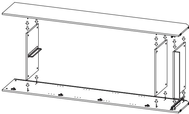
После соединения эксцентрики закрутить по часовой стрелке до упора.
