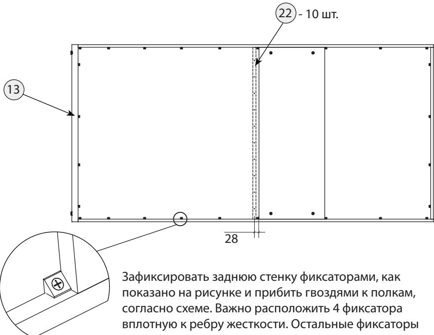
Зафиксировать заднюю стенку фиксаторами, как показано на рисунке и прибить гвоздями к полкам, согласно схеме. Важно расположить 4 фиксатора вплотную к ребру жесткости. Остальные фиксаторы распределить равномерно.
