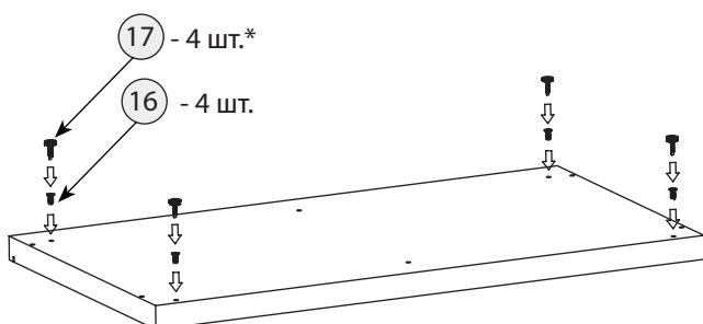
\* - подплатник войлочный 14 использовать в зависимости от типа напольного покрытия (по необходимости), чтобы избежать его повреждения
