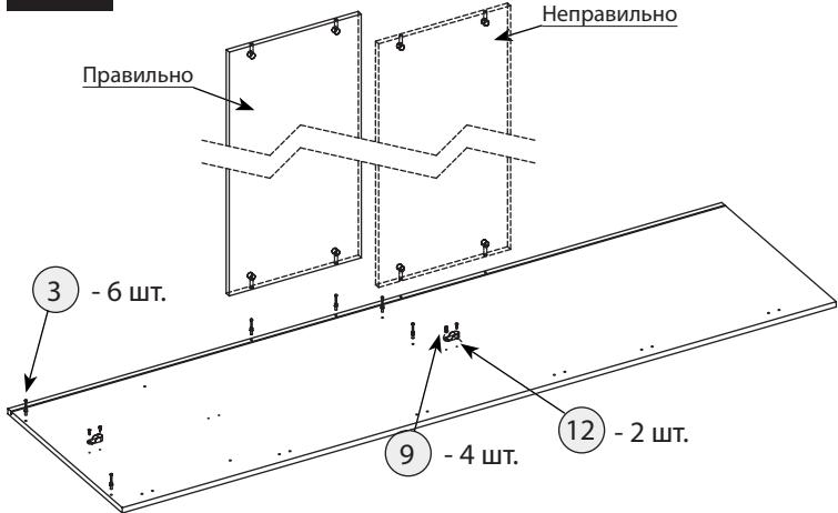
Дюбеля под ребро жесткости устанавливать согласно рисунку
