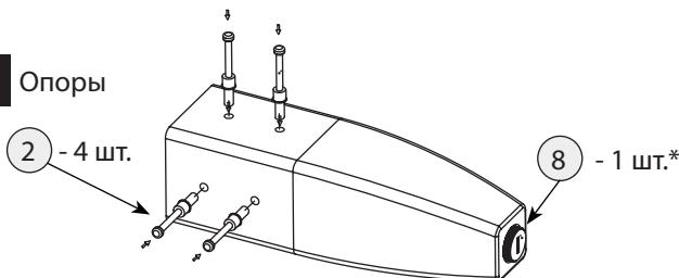
\* под пятник войлочный (11) использовать в зависимости от типа напольного покрытия (по необходимости), чтобы избежать его повреждения
