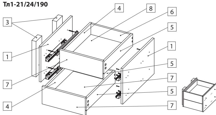
**Тл1-22** Предназначен для установки в шкаф Тл1-07, 07С
