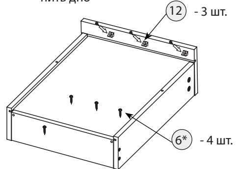
\*Необходимо предварительно просверлить отверстия строго по центру торца задней стенки сверлом d=3мм, глубиной 25мм. Количество отверстий = количеству шурупов.
