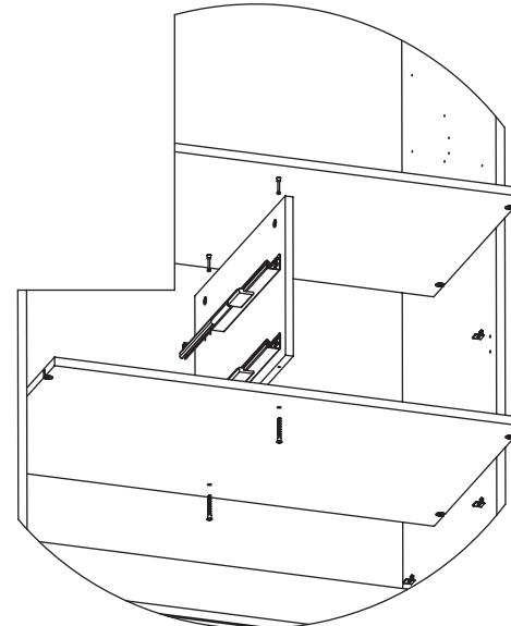
**Шаг 14** Установка стенки вертикальной.
