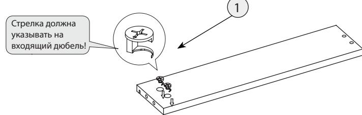
**Шаг 3** Сборка корпуса ящика
