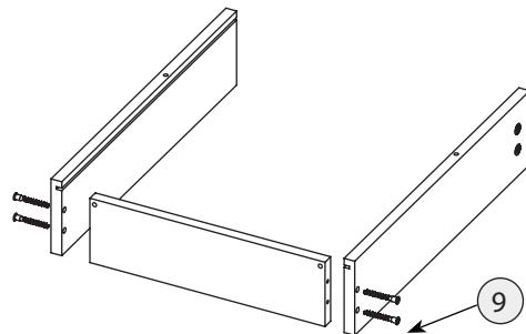
**Шаг 5** Для Тл1-23: Установка опорной планки
