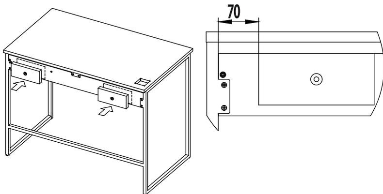
**ВНИМАНИЕ!** Изделие должно быть прикреплено к стене с помощью прилагаемого крепежа который подходит для крепления навесного шкафа к стене из бетона или кирпича без пустот. Всегда выбирайте крепеж который подходит к материалу ваших стен. Если прилагаемый крепеж не подходит к вашим стенам обратитесь в специализированный магазин. Предварительно просверлить отверстия диаметром 5 мм в царге стола.
