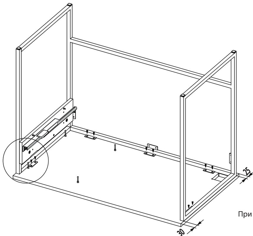
1. Перед установкой опоры, закрепить стенку боковую. Опору выровнять по углу боковой стенки и зафиксировать шурупами по длинной балке.
