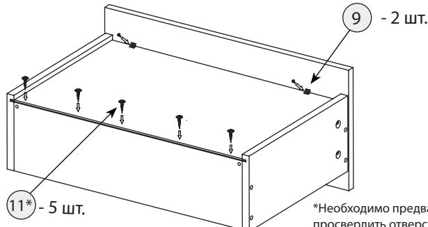
\*Необходимо предварительно просверлить отверстия строго по центру торца задней стенки сверлом d=3мм, глубиной 25мм. Количество отверстий = количеству шурупов.
