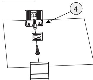
Внимание! Изделие должно быть закреплено на стене с помощью прилагаемого крепежа, который подходит для крепления шкафа к стене из бетона или кирпича без пустот. Всегда выбирайте крепеж, который подходит к материалу Ваших стен. Если прилагаемый крепеж не подходит к Вашим стенам, обратитесь в специализированный магазин.
