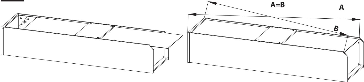
Проверить длину диагоналей, **A=B**. Прибить гвоздями заднюю стенку к стенке нижней согласно схеме и закрепить ее в пазах стенок боковых и крышки фиксаторами задней стенки.
