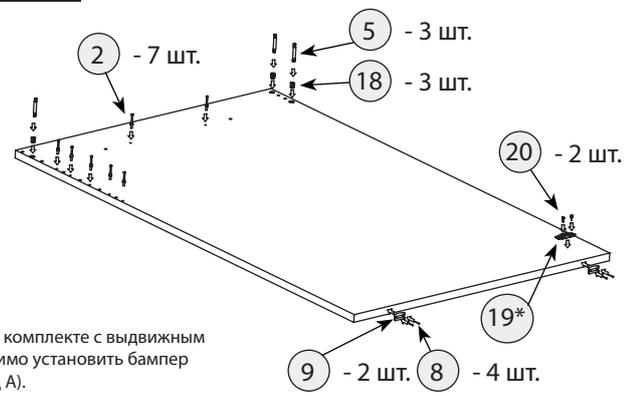
\*При использовании кровати в комплекте с выдвигаемым столом или кроватью, необходимо установить бампер (фиксатор) согласно схеме (Вид А).
