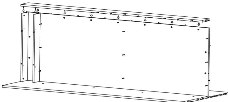
После соединения эксцентрики закрутить по часовой стрелке до упора.
