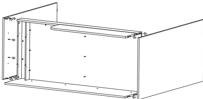
После соединения эксцентрики закрутить по часовой стрелке до упора.
