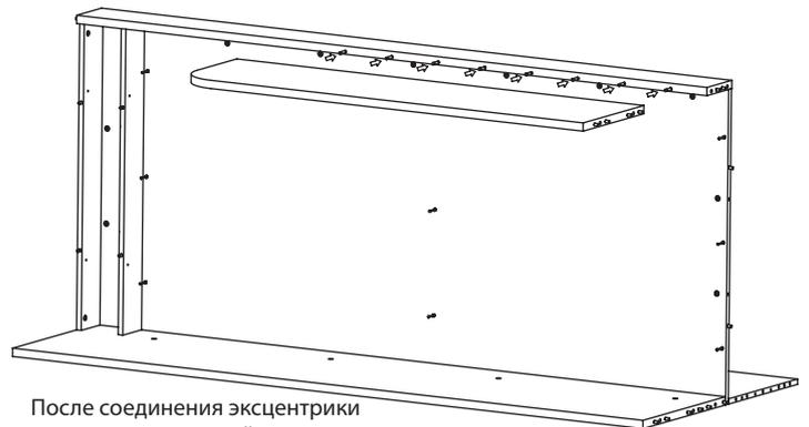
После соединения эксцентрики закрутить по часовой стрелке до упора.
