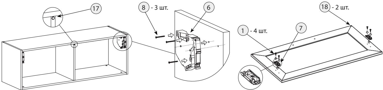
Расположить подъемник на детали, совместив штифтовые отверстия. Зафиксировать шурупами.
