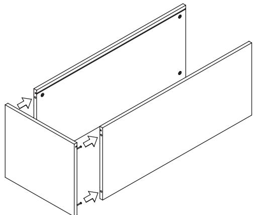
После соединения эксцентрики закрутить по часовой стрелке до упора.
