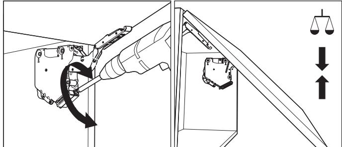
Отрегулируйте усилие откidyивания двери на подъемнике. Дверь должна останавливаться в любом положении при открытии на угол больше 45°.
