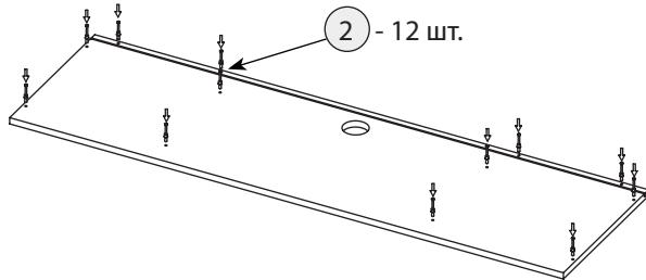
**Шаг 13** Установка деталей на крышку верхнюю
