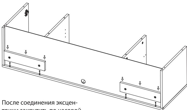
После соединения эксцентрики закрутить по часовой стрелке до упора.
