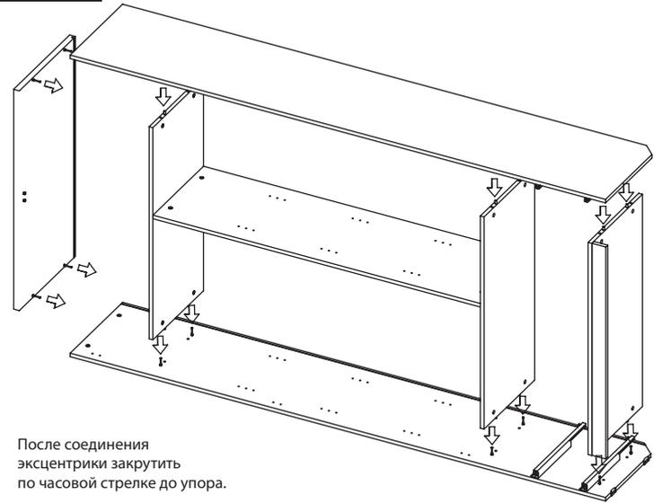
После соединения эксцентрики закрутить по часовой стрелке до упора.
