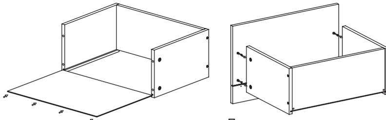
После соединения эксцентрики закрутить по часовой стрелке до упора.
