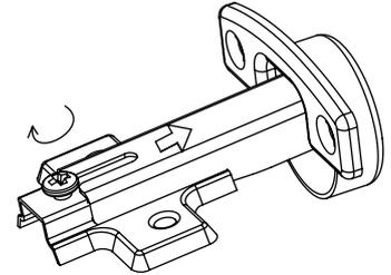
После установки зафиксировать при помощи винта.
