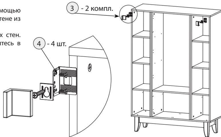
В случае, если модули устанавливаются на общем основании, их обязательно следует закрепить к стене. Для этого используется комплект навесов, расположенных в пакете фурнитуры основания.
