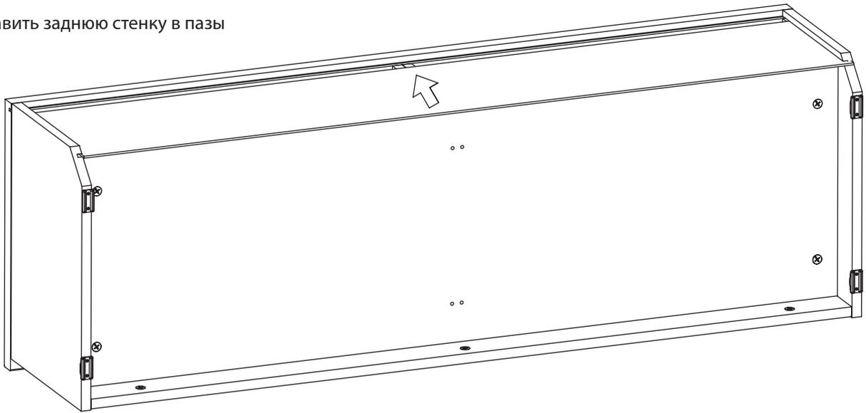
**Шаг 9** Проверить длину диагоналей. далее прибить заднюю стенку гвоздями к стенке горизонтальной нижней и закрепить ее в пазах стенок боковых фиксаторами задней стенки.
