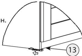
Регулировка ящика по высоте производится с помощью поворота регулировочного колесика (+3 мм)
