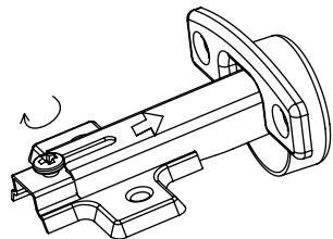
После установки зафиксировать при помощи винта.
