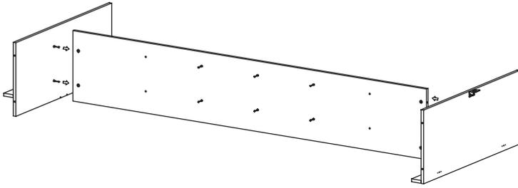
После соединения эксцентрики закрутить по часовой стрелке до упора.
