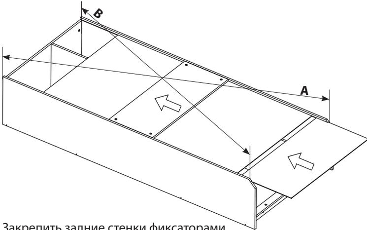
Закрепить задние стенки фиксаторами и шурупами, как показано на рисунке, и прибить гвоздями к стенке нижней и верхней, согласно схеме.
