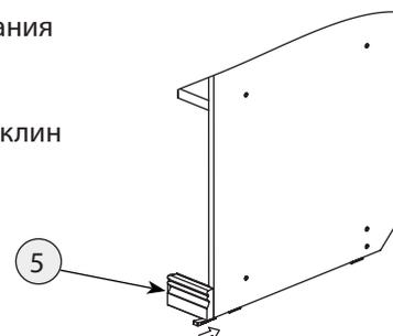
**Шаг 22** После установки изделия и регулировки всех механизмов необходимо все отверстия и видимые эксцентрики минификсов закрыть заглушками.**Правила по эксплуатации и уходу за мебелью**
