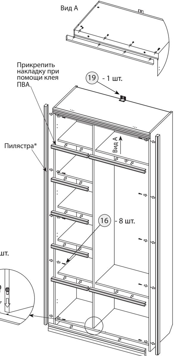
\*Устанавливаются в зависимости от вида композиции и комплектации. Для установки пилястры досверлить 5 отверстий  $\varnothing 5$  мм.
