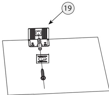
Изделие должно быть прикреплено к стене с помощью прилагаемого крепежа который подходит для крепления шкафа к стене из бетона или кирпича без пустот. Всегда выбирайте крепеж который подходит к материалу Ваших стен. Если прилагаемый крепеж не подходит к Вашим стенам обратитесь в специализированный магазин
