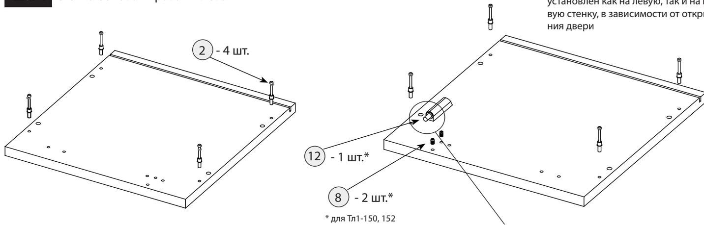
Для Тл1-150, 152: Толкатель может быть установлен как на левую, так и на правую стенку, в зависимости от открывания двери
