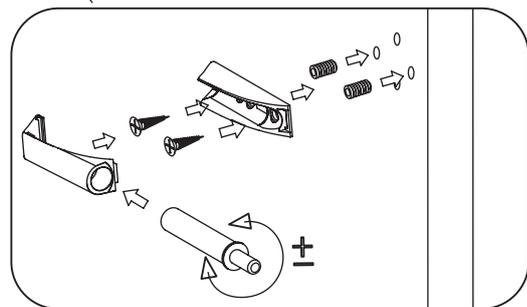
Монтаж толкателя на стенке, противоположной петлям.
