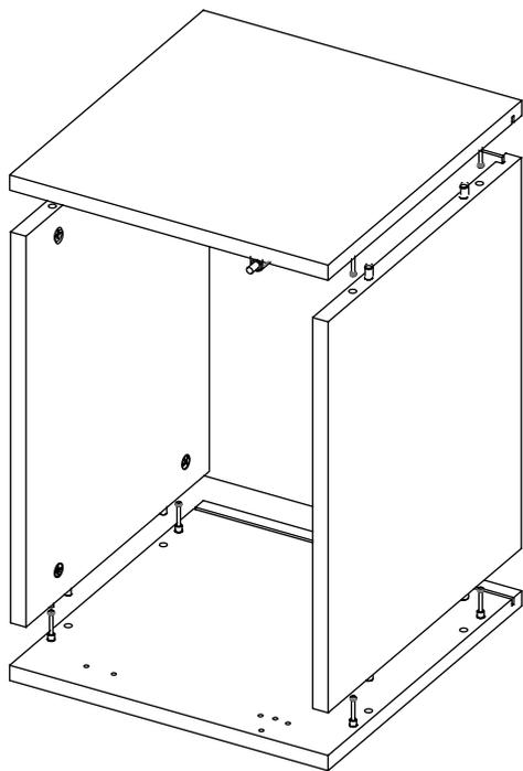
После соединения эксцентрики закрутить по часовой стрелке до упора.
