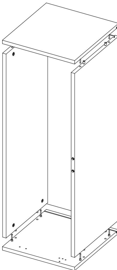
После соединения эксцентрики закрутить по часовой стрелке до упора.
