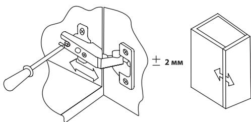
После установки зафиксируйте при помощи винта.
