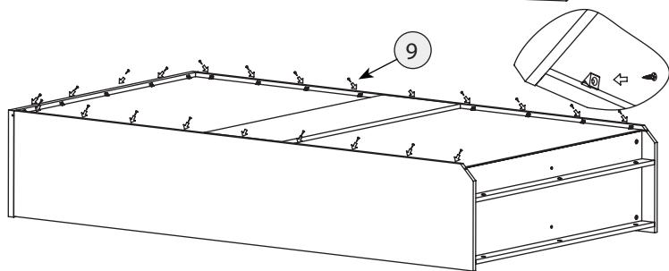
Проверить длину диагоналей, **A=B**. Прибить гвоздями заднюю стенку к стенке нижней согласно схеме и закрепить ее в пазах стенок боковых и крышки фиксаторами задней стенки.
