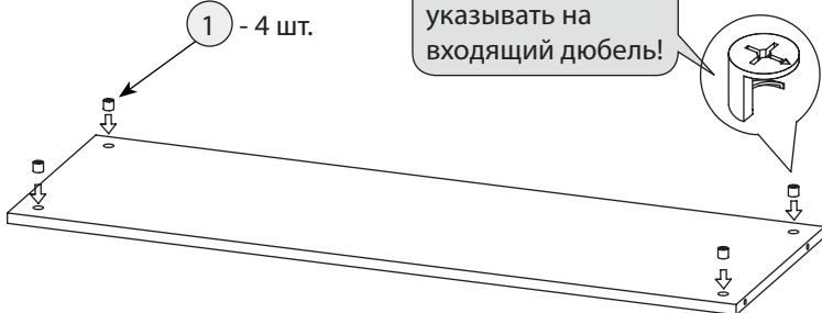
**Шаг 6** Соединить перегородку с нижней стенкой и стенкой горизонтальной
