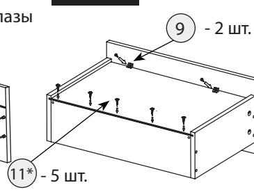
\*Необходимо предварительно просверлить отверстия строго по центру торца задней стенки сверлом d=3мм, глубиной 25мм. Количество отверстий = количеству шурупов.
