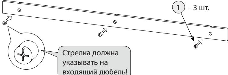
**Шаг 4** Ребро жесткости
