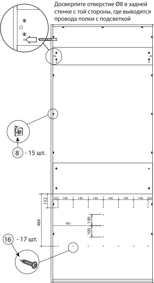
\* - в случае установки ящичных блоков Т1-22, использовать стенку вертикальную шкафа (D.6481-02) в качестве подпорки, при закручивании шурупов в шаге 19. После фиксации задней стенки ее можно убрать.
