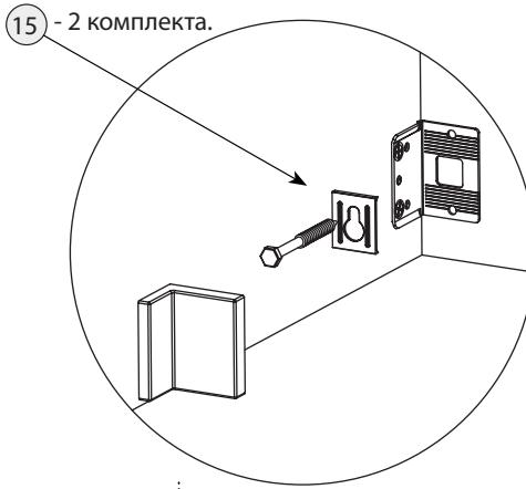
Изделие должно быть прикреплено к стене с помощью прилагаемого крепежа который подходит для крепления шкафа к стене из бетона или кирпича без пустот. Всегда выбирайте крепеж который подходит к материалу Ваших стен. Если прилагаемый крепеж не подходит к вашим стенам, обратитесь в специализированный магазин.
